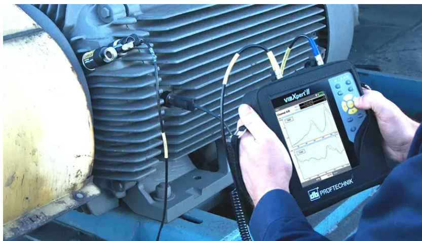
1.3 Сурет – Діріл диагностикасының жұмыс істеуі принципі
