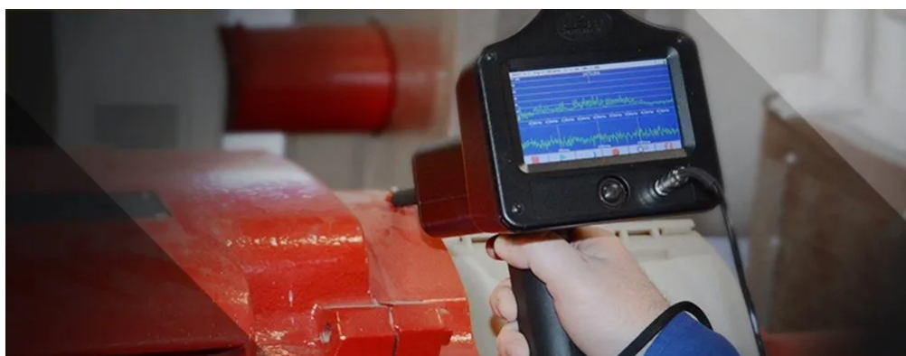
1.7 Сурет – Акустикалық-эмиссиялық бақылау
