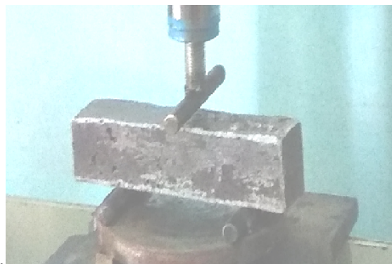
2.9 Сурет – Иілу сынағына арналған престаң қондырмасы
