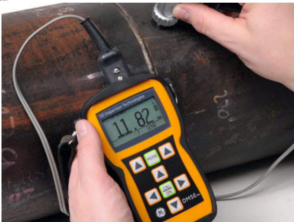
1.8 Сурет – Ультрадыбыстық қалыңдық тексеру
